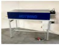
**Trockenkanal HOTWIND, Modell 2, Band 500mm, Durchlass 100mm**
