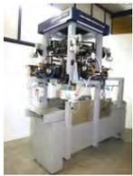
**Vollautomatischer Druckturm SSE1 für den Kistendruck**
